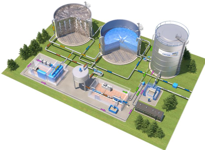
Bildunterschrift: Verfahrensbeispiel für eine Biomar OBR aerobe Abwasserbehandlung (Sequence batch reactor), die bei der Laiterie Soummam eingesetzt wird.
