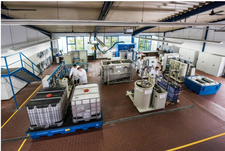
Bild: Im EnviroChemie-Technikum werden mit Abwasserproben des Kunden die passenden verfahrenstechnischen Behandlungsschritte und die Behandlungsparameter ermittelt.
