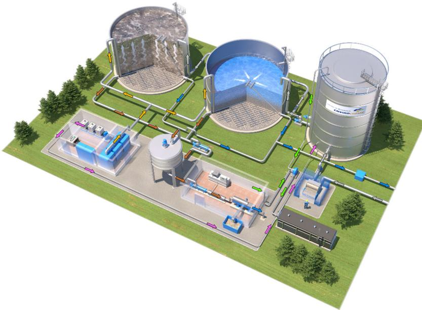
Légende image : Exemple de procédé de traitement aérobique Biomar OBR (réacteur séquentiel discontinu) des eaux usées tel que celui qui sera utilisé pour la Laiterie Soummam.
