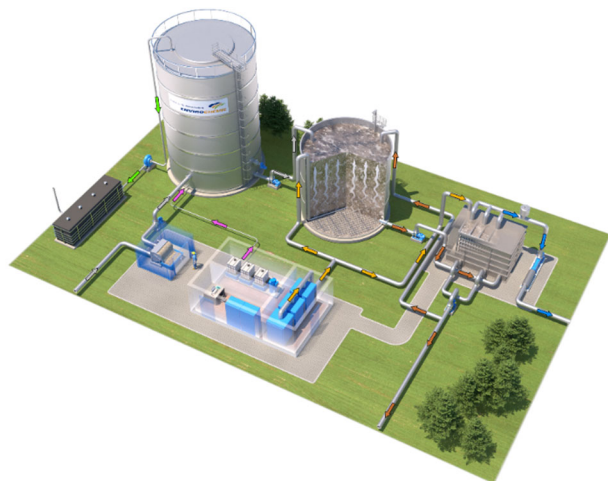
Image : Exemple de procédé de traitement des eaux usées par biologie de membrane Biomar, avec des cuves de mélange et d'équilibrage, un niveau de purification aérobie et une unité de
