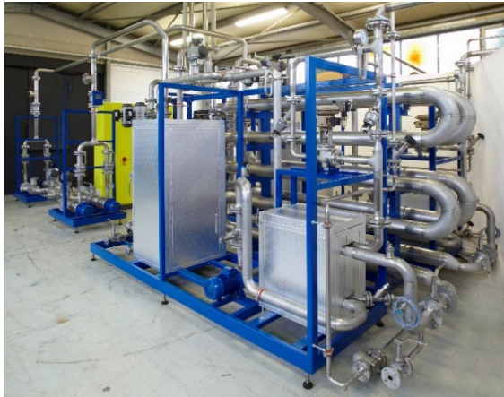
Bild: EnviroDTS Sterifix E15000 Abwassersterilisationsanlage zur sicheren Inaktivierung wirksamer Abwasserbestandteile.
