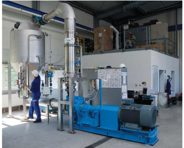
Fertigung der Ultrafiltrationsanlage zum Glasrecycling
