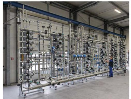
Werksaufnahme einer Envirochem ION Ionentauschanlage für die Entsalzung und Entfärbung von Sorbitol
