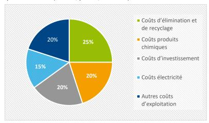
Image : Répartition des coûts totaux du traitement des eaux usées et de l'exploitation de l'installation
