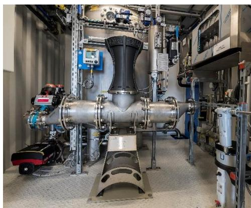
Envocem AOP: sichere Entfernung von Pharma-Wirkstoffen aus dem Abwasser mittels Hochleistungsoxidationsverfahren.
