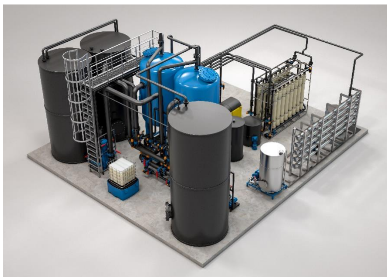
Abbildung 5: 3D-Modell der installierten Anlage, die jährlich 188.000 \text{ m}^3 Wasser in Trinkwasserqualität produziert und dabei Brüdenkondensat als Wasserquelle nutzt
