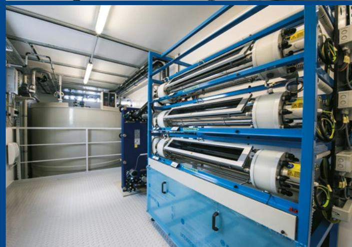
**UV-System mit erweiterter Oxidation, gebaut als EnvioModul-Anlage für die pharmazeutische Industrie**
