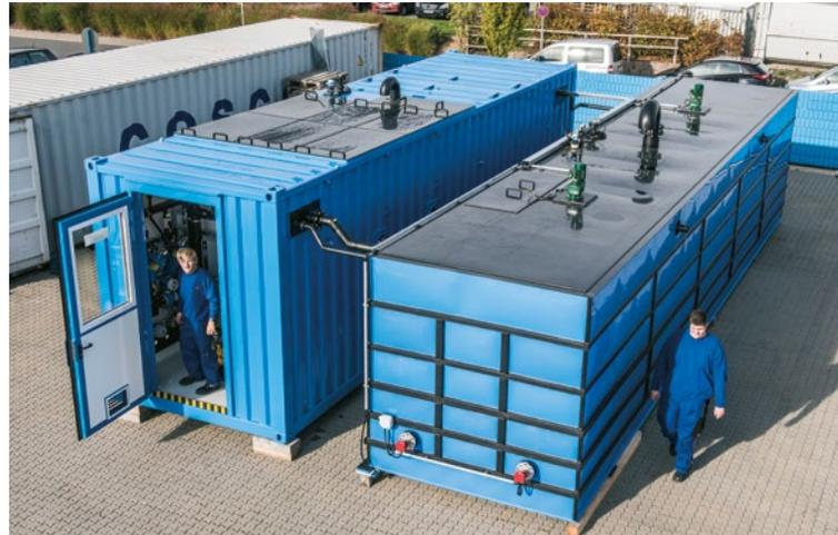
**Vormontage eines modularen EnviModul-Anlagensystems mit Biomar® OMB-Membranbiologie**
