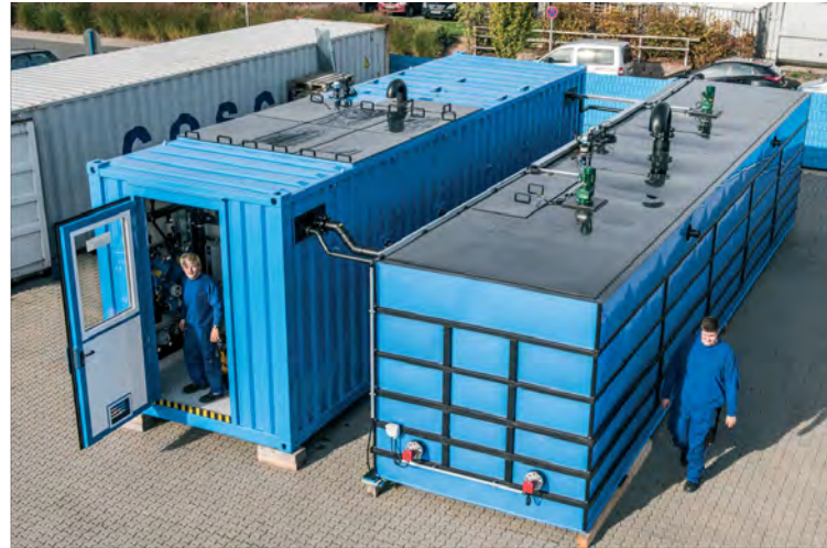
Vormontage eines modularen EnviModul-Anlagensystems mit Biomar® OMB-Membranbiologie
