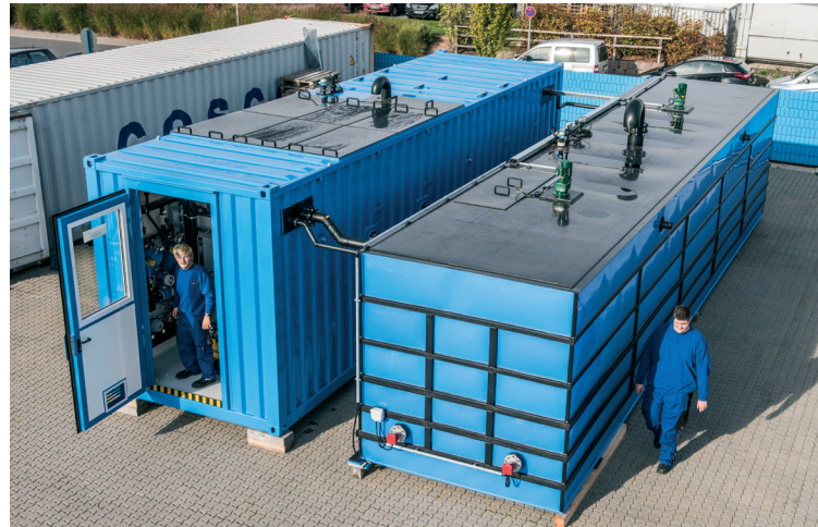
Vormontage eines modularen EnviModul-Anlagensystems mit Biomar® OMB-Membranbiologie
