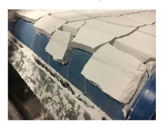
Bilduntertitel: Die optimierte Lackschlammbehandlung liefert einen Filterkuchen mit einem TS-Gehalt von ca. 35%
